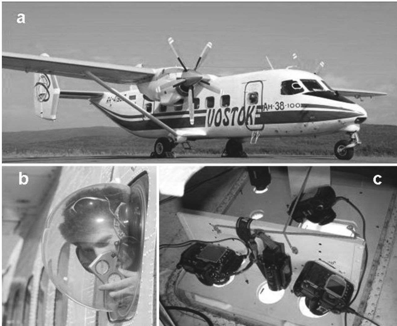
Рис. 1. Самолет-лаборатория Ан-38 «Восток»: а) общий вид; б) блистер для наблюдений; в) установка фото, видеоаппаратуры и ИК-радиометра в нижнем люке
